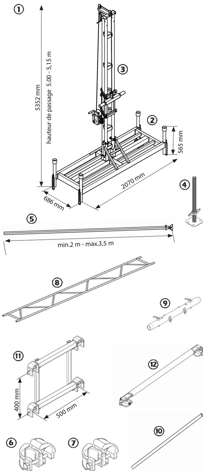
① Mât et support de passage de câbles rapide Art.-Nr. 12 30 00 complet, zingué, poids 173,00 kg (sans socle à vérin)
