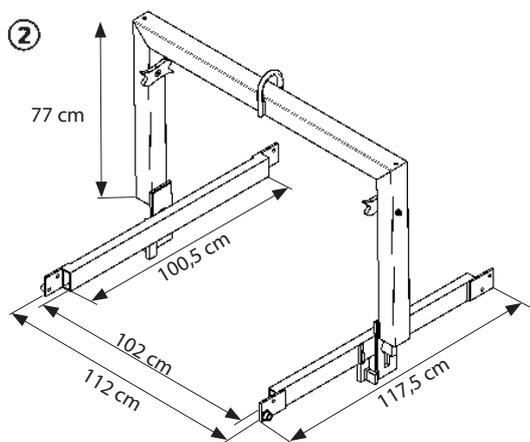
② Dispositif de basculement automatique pour grue pour conteneur multifonction zingué, avec kit d'adaptation et vis poids 43,00 kg Art.-Nr. 55 82 00
