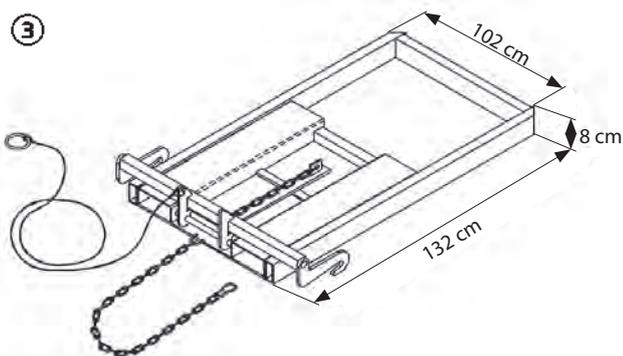
③ Dispositif de basculement pour fourches de chariots élévateurs pour conteneur multifonction zingué, poids 62,00 kg (jusqu'à la section de fourche 15,5 x 5,5 cm) Art.-Nr. 55 83 00
